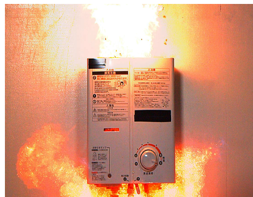
【NITE再現実験】ガス瞬間湯沸器の内部に滞留した未燃ガスに着火する再現実験
